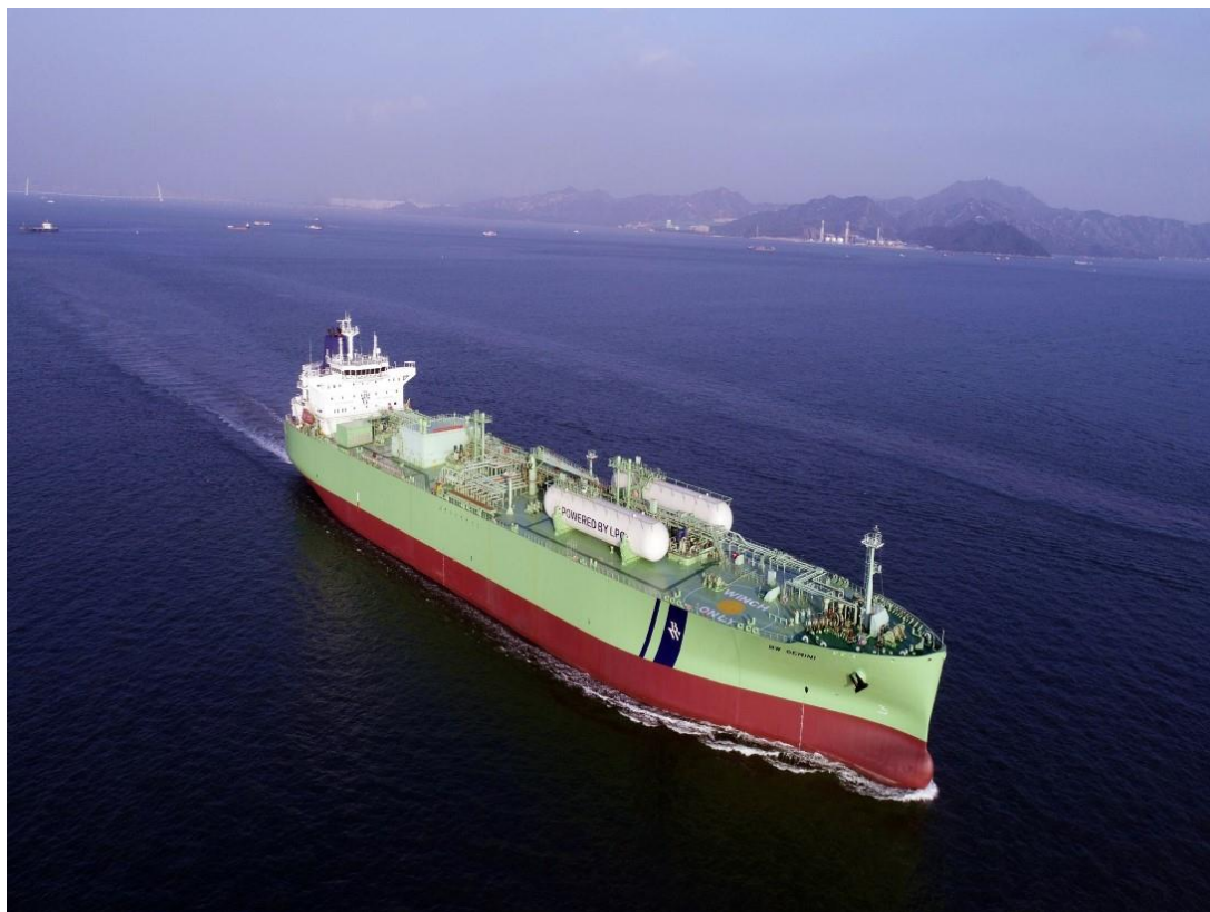
Εικόνα 18: Το VLGC BW Gemini της εταιρείας BW PLG, το πρώτο πλοίο στον κόσμο που λειτουργεί με καύσιμο LPG μετά μετασκευή των μηχανών του από τη MAN
