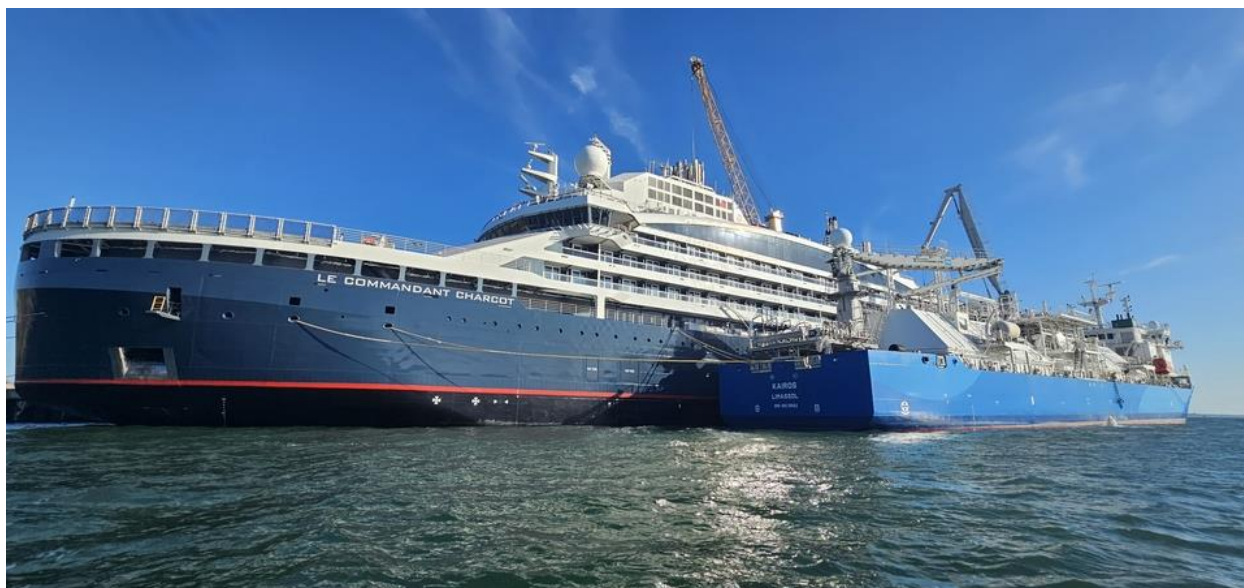
Εικόνα 14: Ανεφοδιασμός δεξαμενοπλοίων με LNG με τη μέθοδο STS (Ship-to-Ship)
