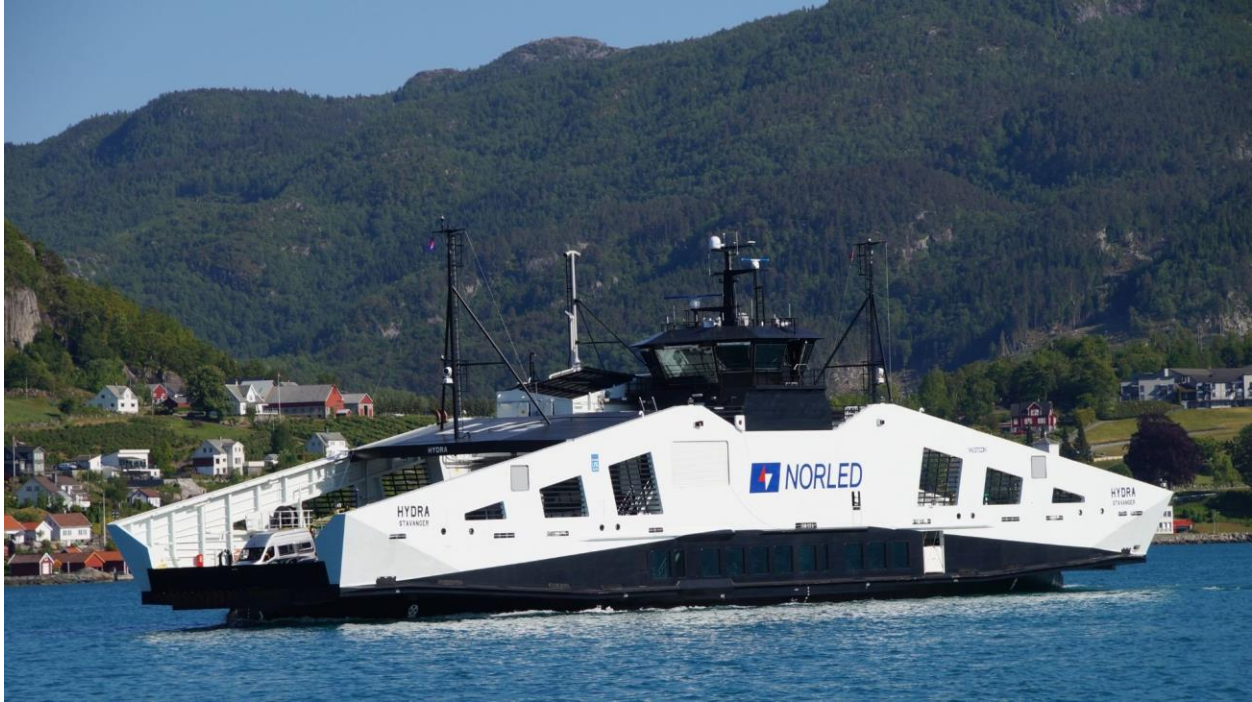
Εικόνα 47: Το φέρυ-μποτ MF Hydra που κινείται με κυψέλες καυσίμου με καύσιμο υγροποιημένο H 2 της νορβηγικής Norled AS
